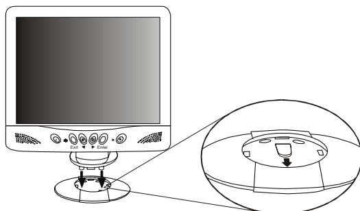
Coloque la parte frontal del monitor en la misma dirección que la flecha que aparece en la base. Dicha flecha indica la parte frontal de la base. Introduzca el monitor en la base hasta que encaje. Oirá un clic.
