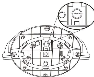
Coloque el monitor boca abajo en una superficie suave. Sujete la parte posterior del monitor con una mano. Pulse el botón de liberación de la base con la otra mano y empuje hacia afuera en la dirección del flecha para extraer la base del monitor.
