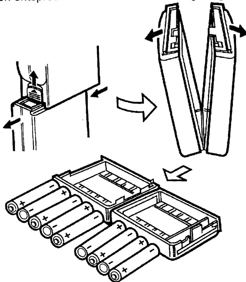
**WICHTIG:** Wenn die Spannung in den Zellen absinkt, leuchtet die BATT.LOW-Anzeige und bei gedrückter PTT wird das Display blaß bzw. verschwindet ganz. Dies ist eine normale Reaktion und bedeutet, daß die benötigte Spannung höher ist als die anliegende. Bitte erneuern Sie die leeren Batterien oder laden die Akkus.
