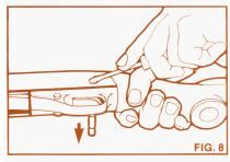
faisant glisser le devant bois en arrière et en le dégageant directement de l'anneau du canon. 5. Ziehen Sie dann den Magazinrohrring mit Lauf nach vorn aus dem Vorderschaft.  Quite el guardamanos del cañón, deslizándo el guardamanos hacia atrás y luego alzándolo hasta que se libre del gancho del cargador en el cañón.
