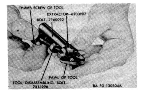
Figure 60. Disassembling bolt.
