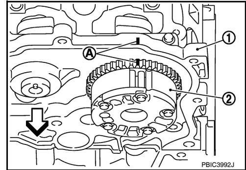
8. Tighten camshaft (INT) sprocket bolt.
