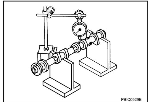
4. If actual runout exceeds the limit, replace the camshaft.
