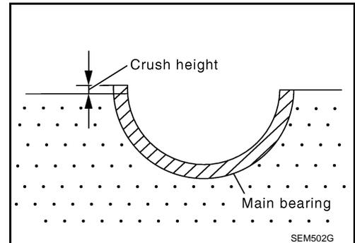
**CRUSH HEIGHT OF CONNECTING ROD BEARING**
