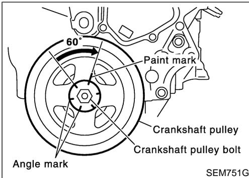
31. Install crankshaft pulley bolt.
