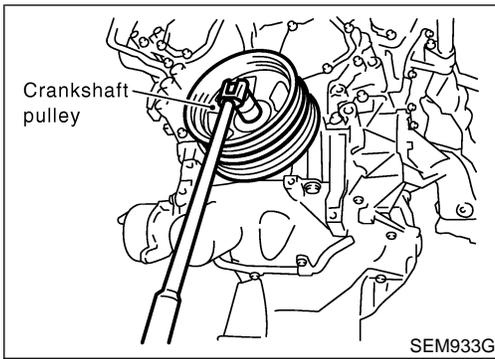
23. Loosen the crankshaft pulley bolt.
