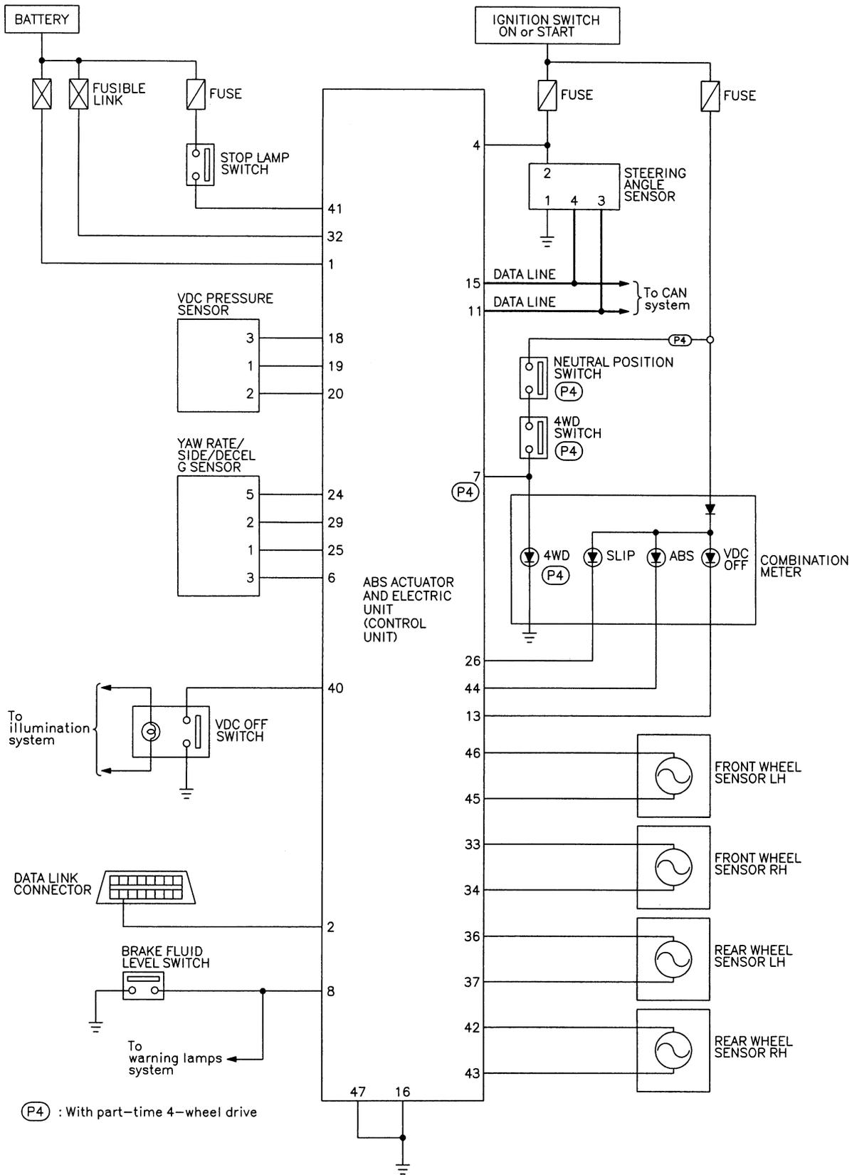
Wiring Diagram — VDC —
