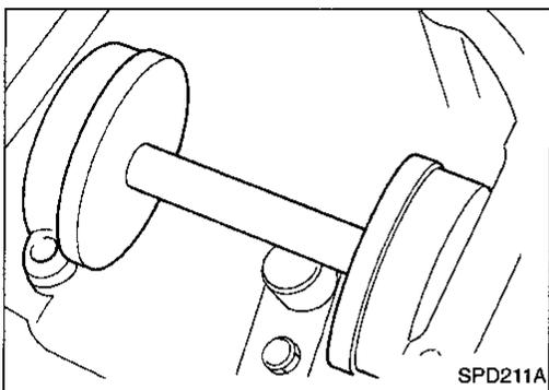
**PINION HEIGHT ADJUSTING WASHER SELECTION**
