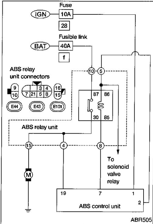
**MOTOR POWER SUPPLY CIRCUIT**
