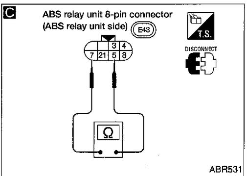
**CONTROL UNIT POWER SUPPLY CIRCUIT**
