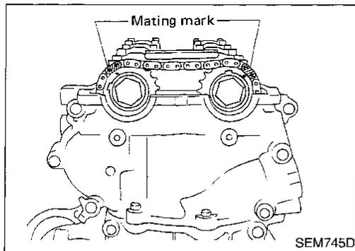
6. Install camshaft sprockets.
