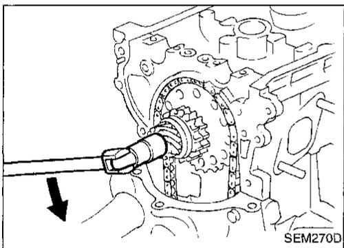
15. Remove idler sprocket bolt.
