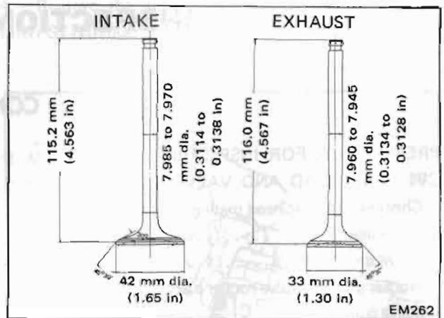
Fig. EM-30 Valve dimensions
