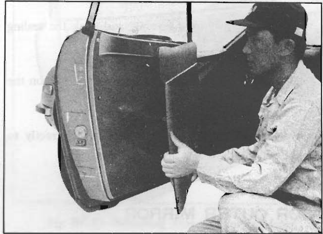
Fig. BF-26 Removing door finish
